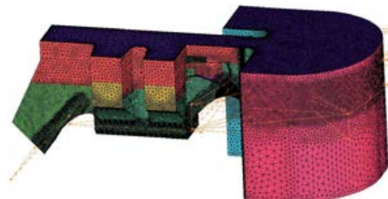
Obrázek 2: Ukázka výpočetní sítě pro jednu polohu segmentu a hladiny v nádrži
