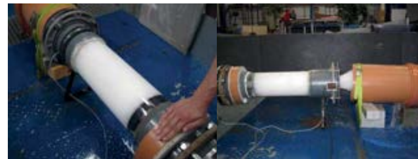
Obrázek 2: Testování hydraulické funkce aerátoru v laboratorních podmínkách – funkční vzorek aerátoru DN200
