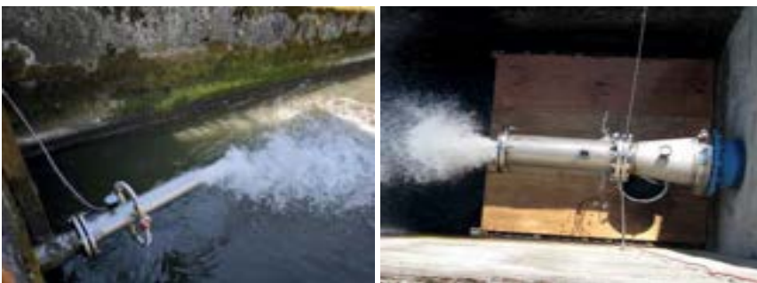
Obrázek 4: Testování prototypů aerátoru na VD Džbán (vlevo) a VD Kličava (vpravo)
