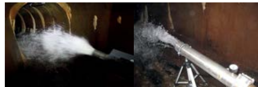
Obrázek 3: Testování prototypů aerátoru DN100 na sanační výpusti VD Jordán – pohled po proudu do odpadní štol
