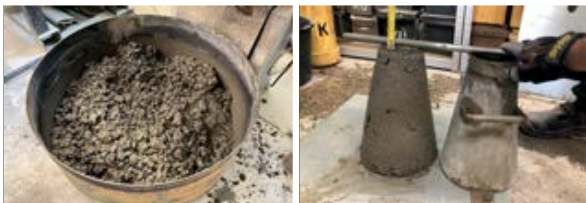
Obrázek 3: Vlevo – čerstvý beton v bubnu míchačky; Vpravo - zkouška konzistence čerstvého betonu sednutím kužele
