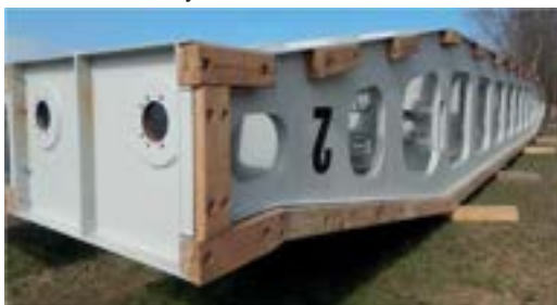
Obrázek 5: Nově vyrobené hradidlo č.2 s osazením těsněním, zatím bez pojezdových kol
