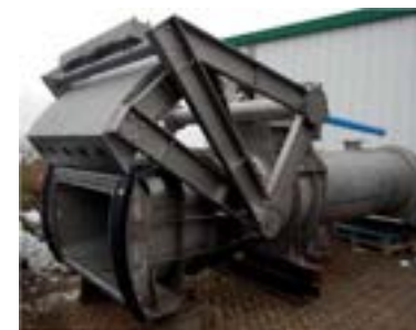
Obrázek 5: Pravá výpust – segmentový uzávěr a část potrubí, dílenská přejímka prosinec 2024
