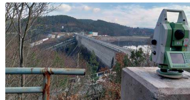
Obrázek 2: Observační pilíř sítě vztazných bodů, totální stanice Leica TM30
