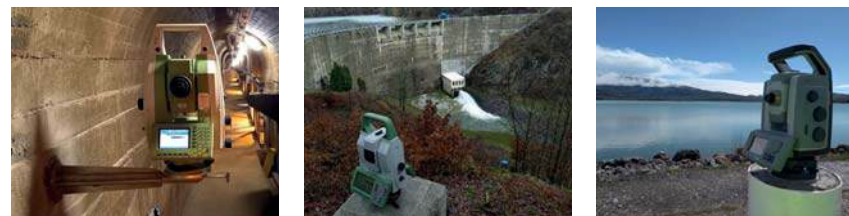
Obrázek 3: Totální stanice Leica TM30 (VD Fláje), Leica TM60 (VD Vrchlice), Trimble S9 HP (VD Shaori, Gruzie)
