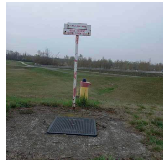
Obrázok 2: Sonda PSD-022 (Spojovacia hrádza – koruna v km 2,948) so snímačom od Regotransu
