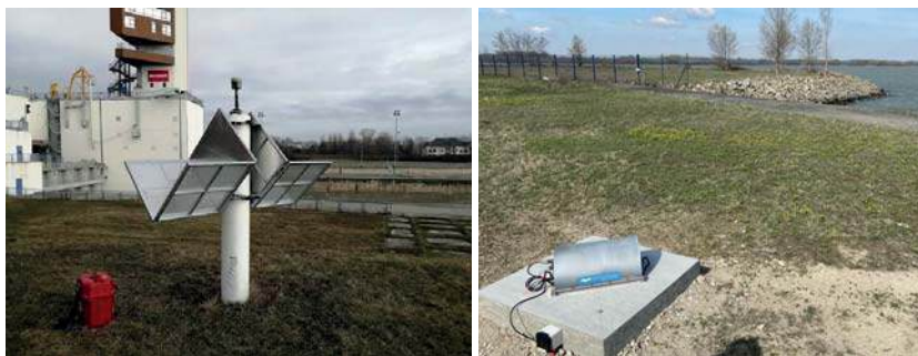
Obrázok 6: Vľavo pasívny radarový odrážač na stupni Gabčíkovo a vpravo aktívny radarový družicový odrážač na stupni Čunovo
