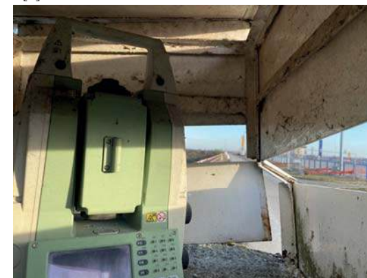
Obrázok 5: Jeden z naprogramovaných tachymetrov osadených pri Plavebných komorách na stupni Gabčíkovo
