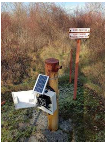
Obrázok 5: Sonda PSR-011 (Prívodný kanál – pravé zázemie v km 1,000 rade A) so snímačom od Altronu
