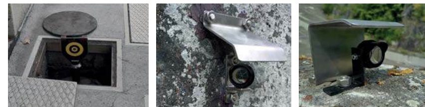
Obrázek 5: Původní terč pro záměrnou přímku a fixní minihranoly na bodech Z1 a B6
