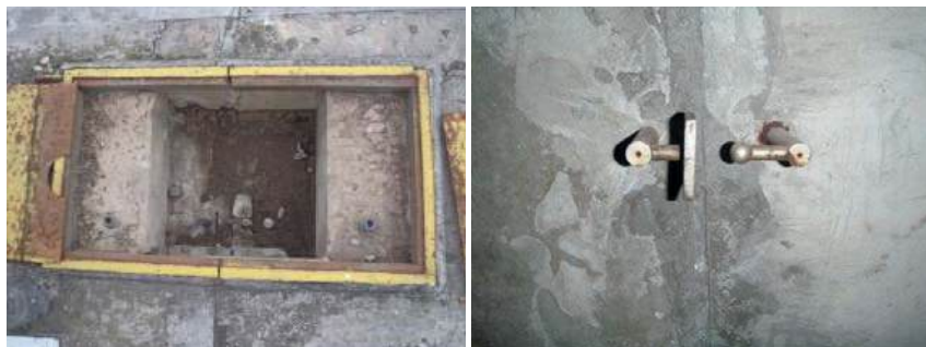
Obrázok 2: Dilatometrické skoby na objektoch VD Gabčíkovo
