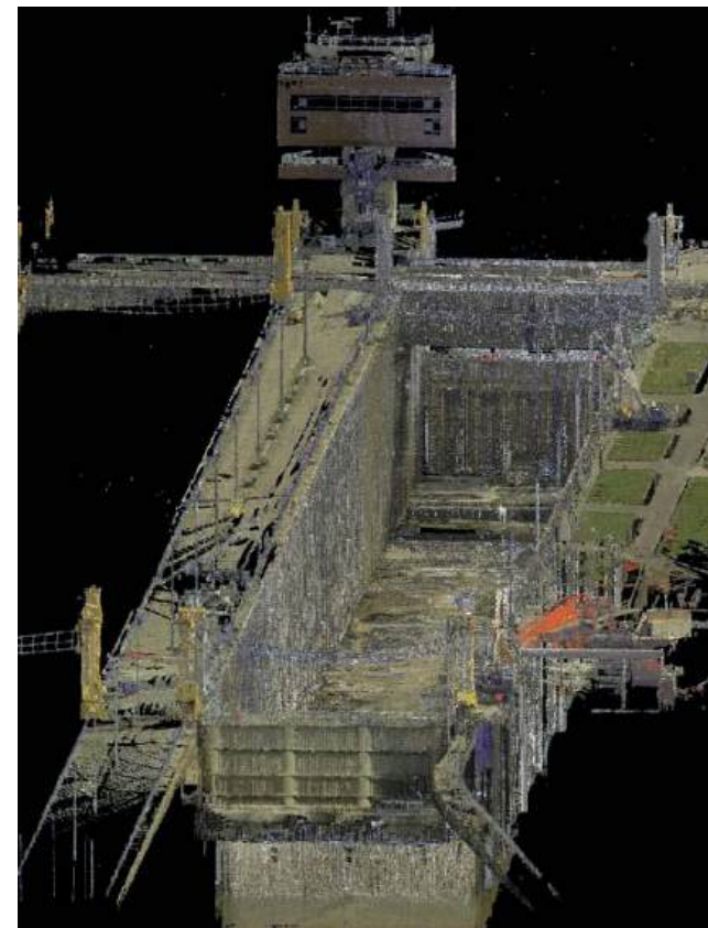
Obrázok 7: Mračno bodov z 3D skenu pravej plavebnej komory
