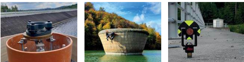
Obrázek 2: Nucená centrace před zálivkou, instalace fixních minihranolů a hranol GMP101 s adaptérem pro zděř 12 mm
