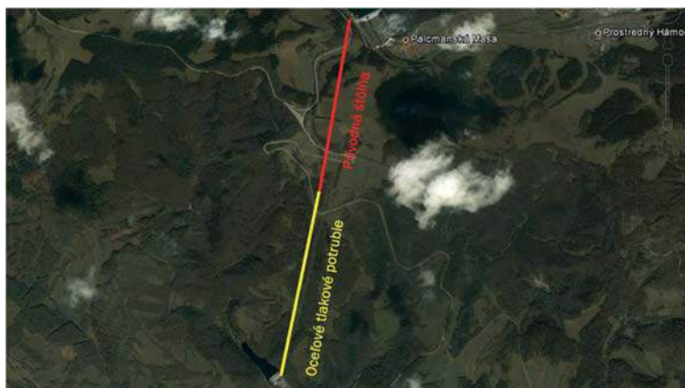
Obrázok 3: Schematická situácia uloženia prírodného potrubia na PVE Vlčia Dolina
