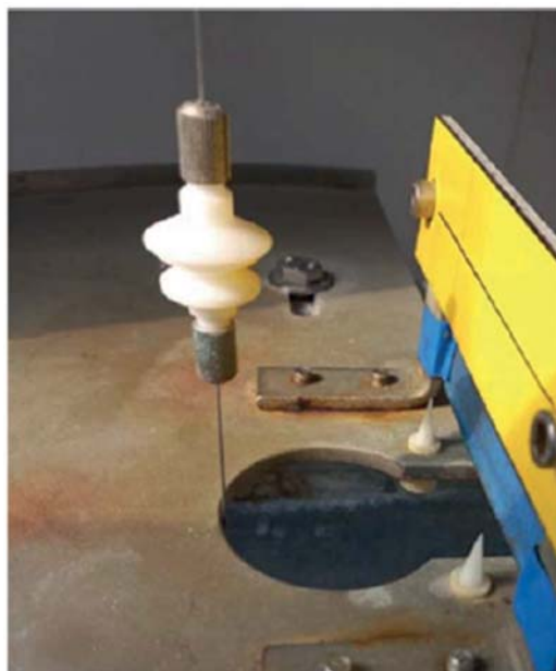
Příklad technických potíží: drát kyvadla dotýkající se čtecího stolku při extrémním posunu klenby proti proudu
