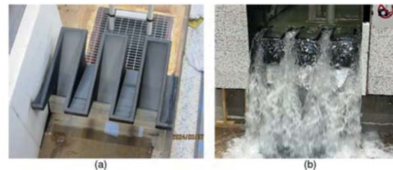
Detailní hydraulický model varianty PKW v měřítku 1:12 v laboratorním žlabu při simulaci návrhového průtoku.
