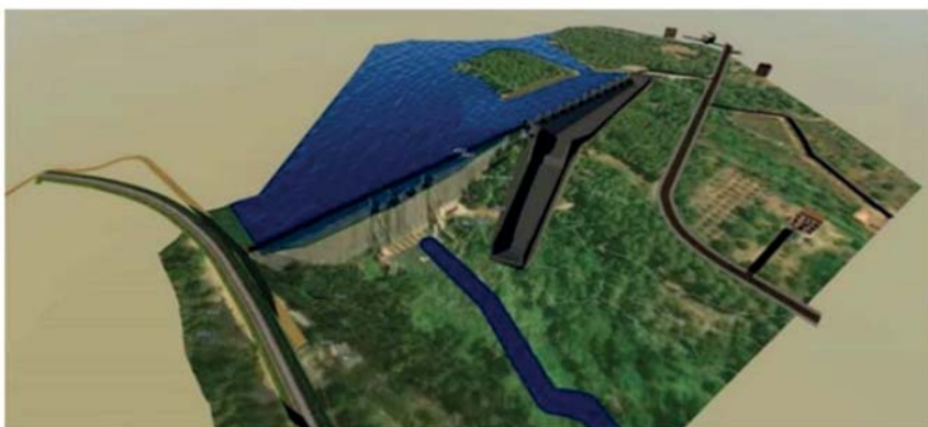
Perspektiva přehrady Regajo s nově navrženým bočním přelivem na levém břehu
