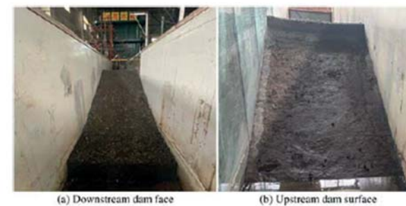
Stav testovacího modelu po 50 hodinách přelévání
