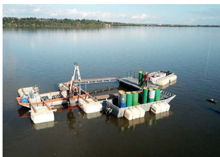
Obrázek 15. Stavební soulodí tvořené zakotveným pontonem, těžební a současně operační lodí s hydraulickou rukou a pochozími plošinami, které umožňovalo posun v kolmé osově rovině.
