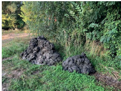
Obrázek 5. První polotovar výrobku. Solidifikovaný sediment – výrobek č. 1 před vyzráním a nadrcením na frakci < 50 mm.
