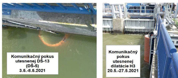
Obrázok 5: Pohľad na realizáciu kontinuálneho pokusu (VV – TBD).
