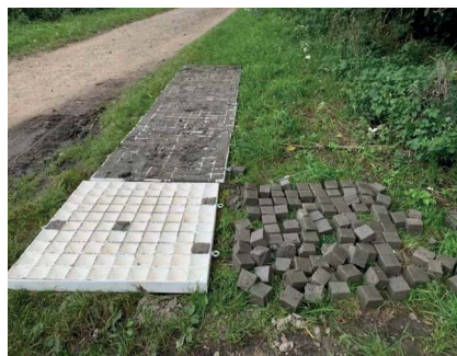
Obrázek 7. Výrobek č. 2 – krychle ze solidifikovaného sedimentu.
