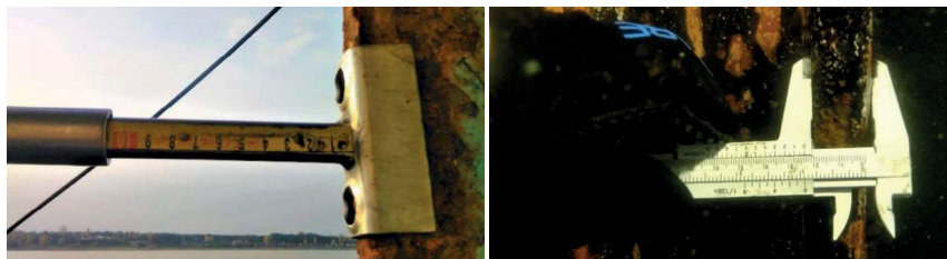
Obrázek 3 a 4: Měření rozteče vodičích hran a tloušťky přírub ocelových profilů [2].
