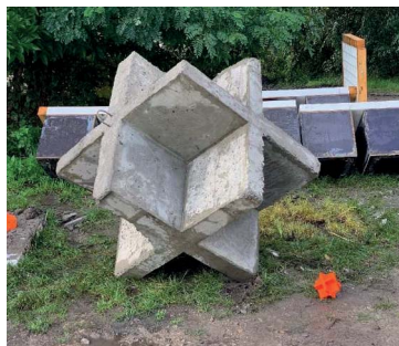
Obrázek 11. Výrobek č. 4 – vlnolamu „kříže“ s jeho modelem.
