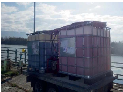
Obrázok 15 a 16: Použitá injektážna zmes WEBAC PUR seal (polyuretánová živica).
