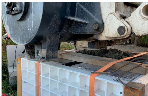
Obrázek 10. Pohled na plnění formy zušlechťeným sedimentem.
