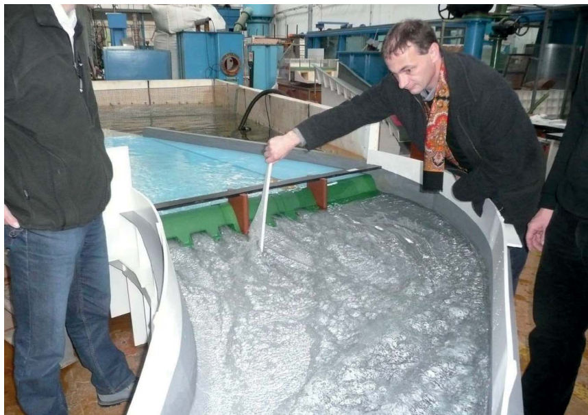
Obrázek 3: práce na hydraulickém modelu – ve funkci již nové levé přelivné pole.
