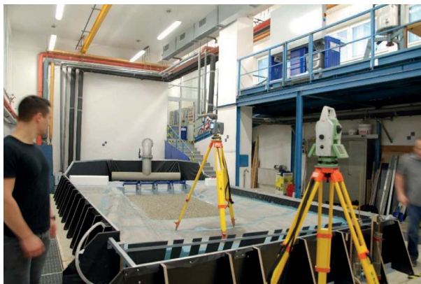
Obrázok 7: Laserové skenovanie a meranie polohy vličovacích značiek pre potreby fotogrametrickej metódy.
