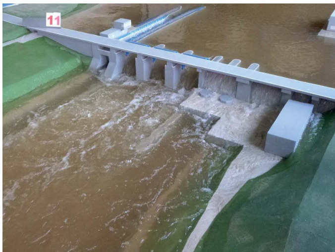
Obrázek 5: Model 1:50, celkový pohled z levého břehu dolní vody, Q_{10000} = 2\,600 \text{ m}^3/\text{s} .
