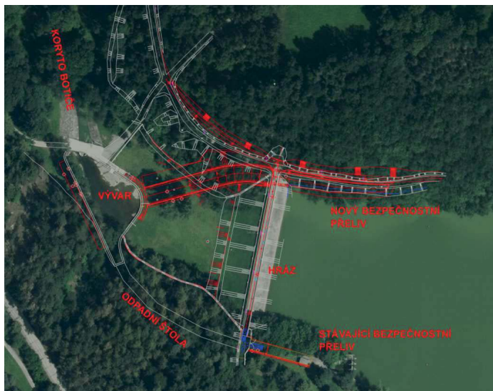
Obrázek 1: Navrhované stavební úpravy včetně nového bezpečnostního přelivu.
