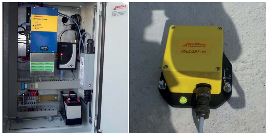
Obrázek 3: Monitoring seismických událostí: záznamová jednotka, seismometr.
