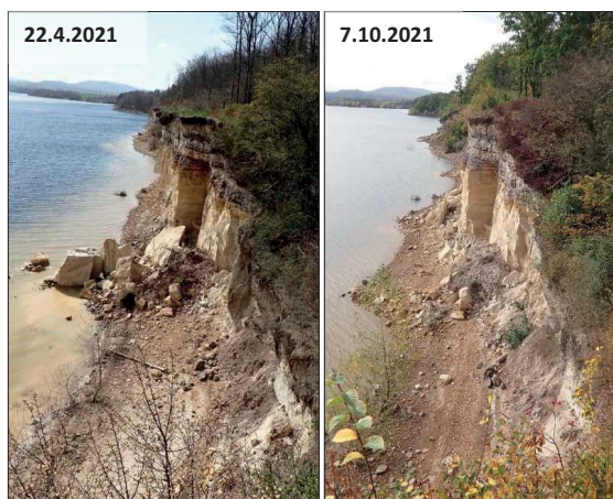
Obrázek 7: Srovnání stavu oblasti sesuté části abrazního srubu po 6-ti měsících, dokládající velmi rychlý odnos materiálu vodou.
