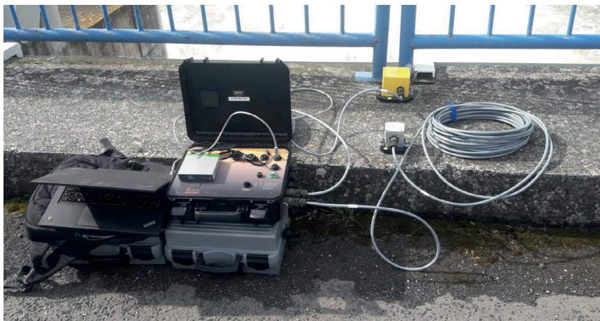
Obrázek 6: Přenosná aparatura pro měření vibrací.
