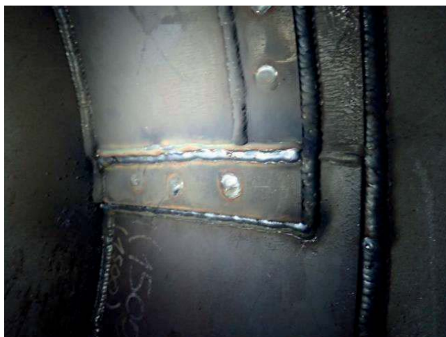
Obrázek 6: Detail překlátování a posílení vnitřní strany ovládací trubky.
